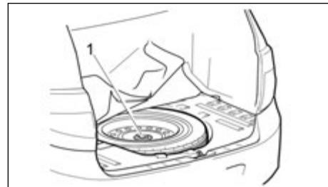
Ваш автомобиль укомплектован полноразмерным запасным колесом ①.
